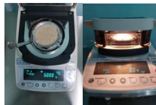
Gambar 3. Proses Pengujian Kadar Air Menggunakan Moisture Balance
